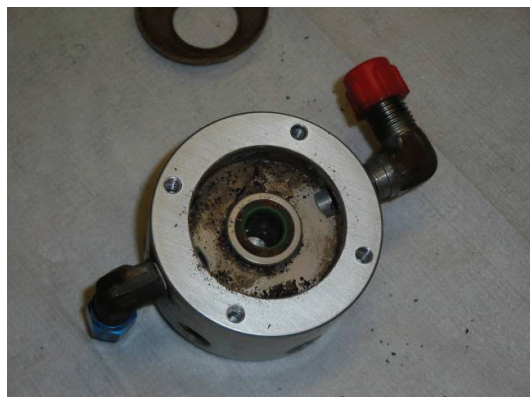
Pollution dans le corps du répartiteur
